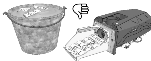
Fig. 16 Lucrări inadmisibile fără grătare
